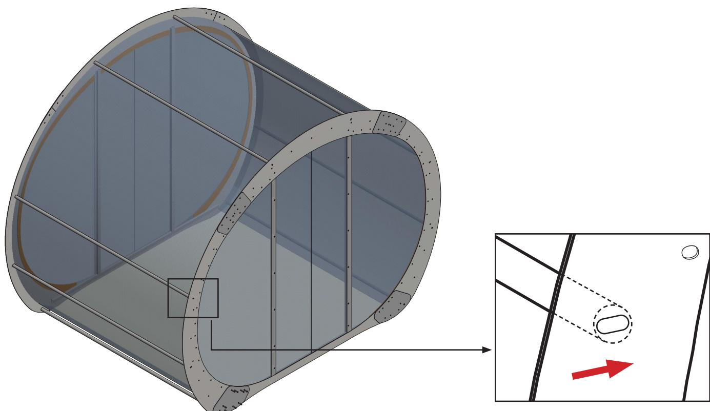
9\_Infilate il lexan tra la guida indicata nel punto 6 e le traverse del punto 7, spingere le traverse nella parte più interna dell'asola.
