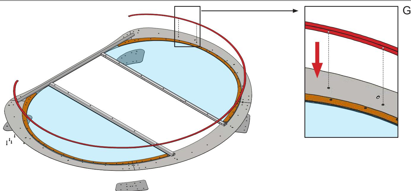
6\_Inserire le guide per il lexan (Disegno G)
